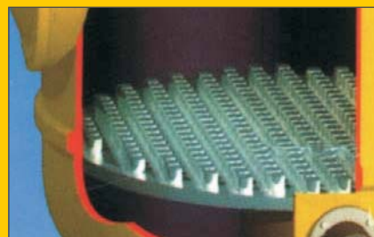
Сменяемое самопродуваемое дюзовое дно
