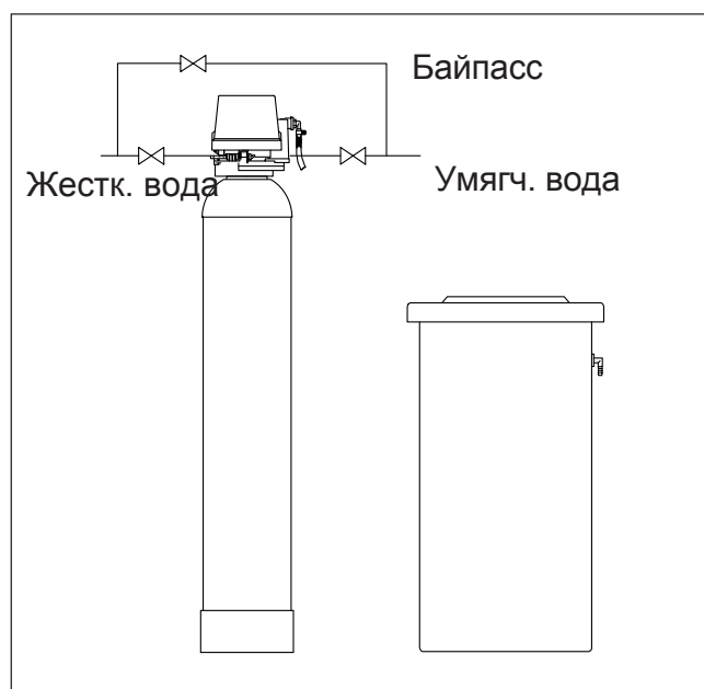
Рис. 4: Монтаж байпасса
